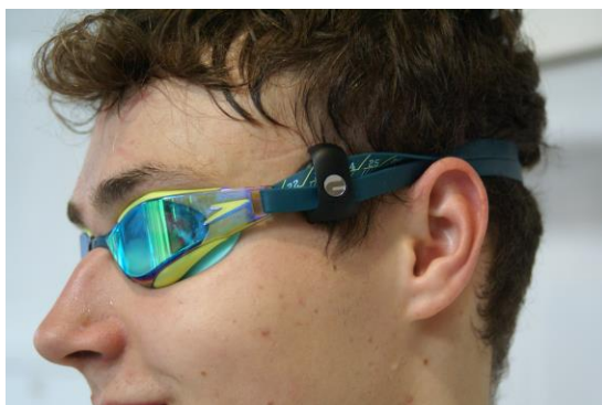
Slika 4. Položaj pulzmetra pritrjenega za očali plavalca, ki je omogočal neprekinjeno snemanje frekvence srca med plavanjem (POLAR OH1) in shranjevanje v spomin računalnika za kasnejše analize.
