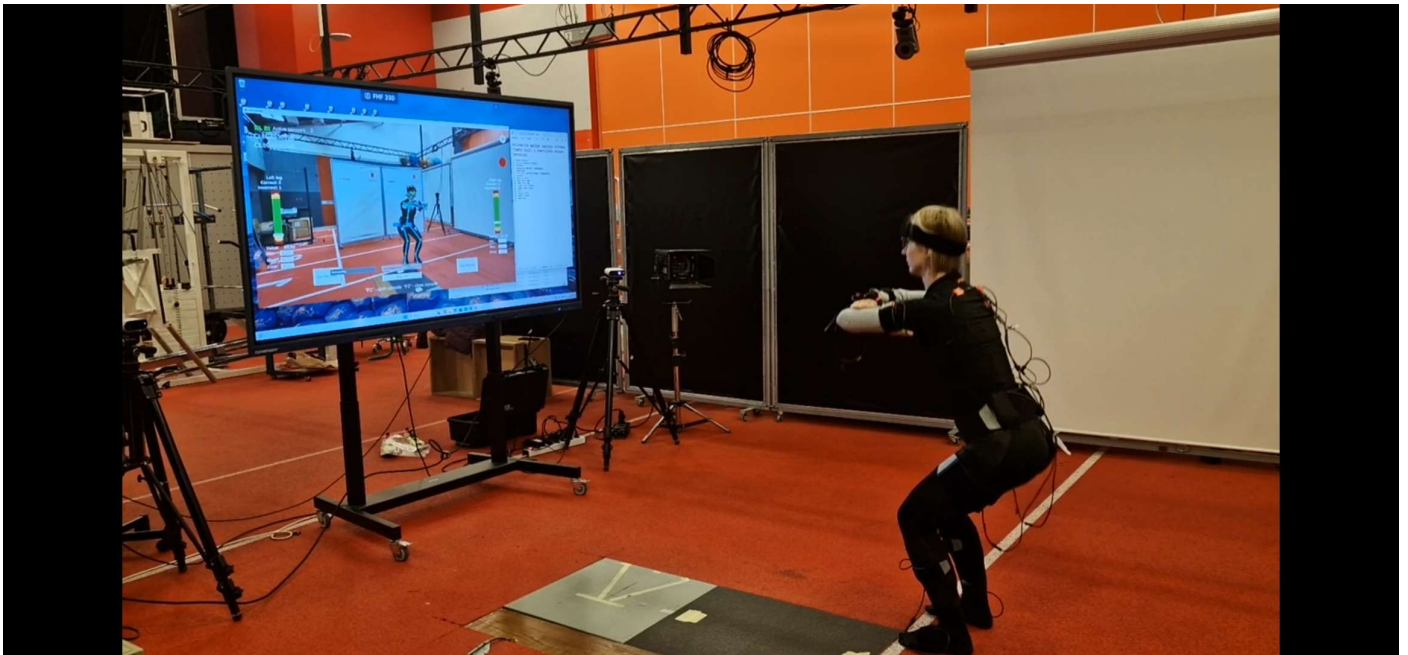
Slika 5: Meritve veljavnosti: sočasno merjenje novo razvite pametne vadbe (Unity) z uveljavljeno inercialno obleko Movella Xsens. Monitor prikazuje sliko v realnem času novo razvitega sistema pametne vadbe z umetno inteligenco na velikem ekranu v laboratoriju za Biomehaniko. V tem primeru je 3D rekonstrukcija prikazana neposredno na vidni sliki Femto Bolt kamer, ki sta postavljeni levo in desno od zaslona.
